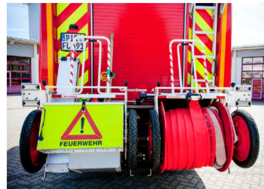
Gut zu sehen: Das Heck des 2013 beschafften Hilfeleistungslöschgruppenfahrzeuges HLF 20 wurde mit einer Verkehrssicherungshaspel ausgestattet (Foto: Feuerwehr Pirna)
